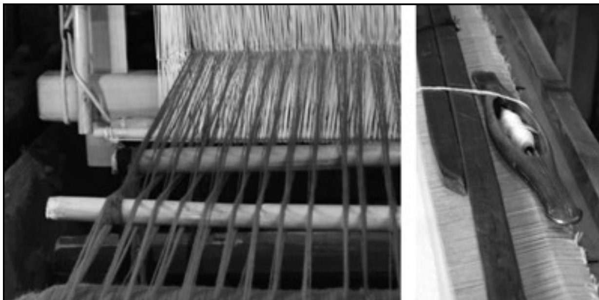
Foto izq.: detalle de la urdimbre del telar | Foto der.: detalle de la lanzadera del telar
