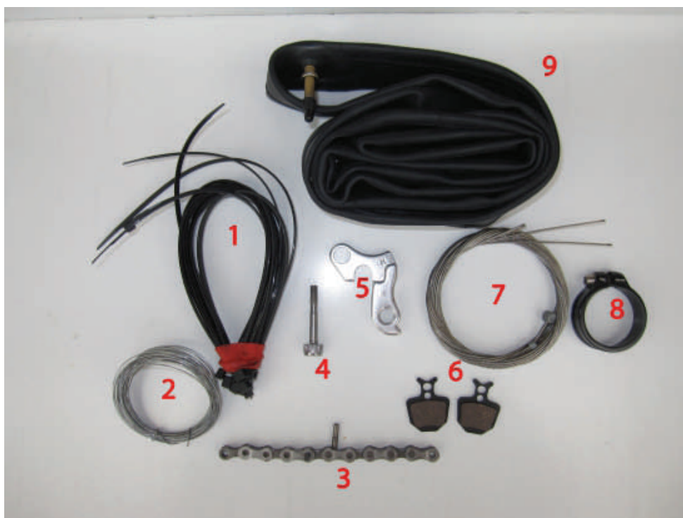
1.-Bridas.2.-Alambre.3.-Eslabones de cadena y bulón.4.-Tornillo cabeza de tija.5.-Patilla de cuadro.6.-Pastillas de freno.7.-Cables cambio y freno.8.-Abrazadera tija sillín.9.-Cámara
